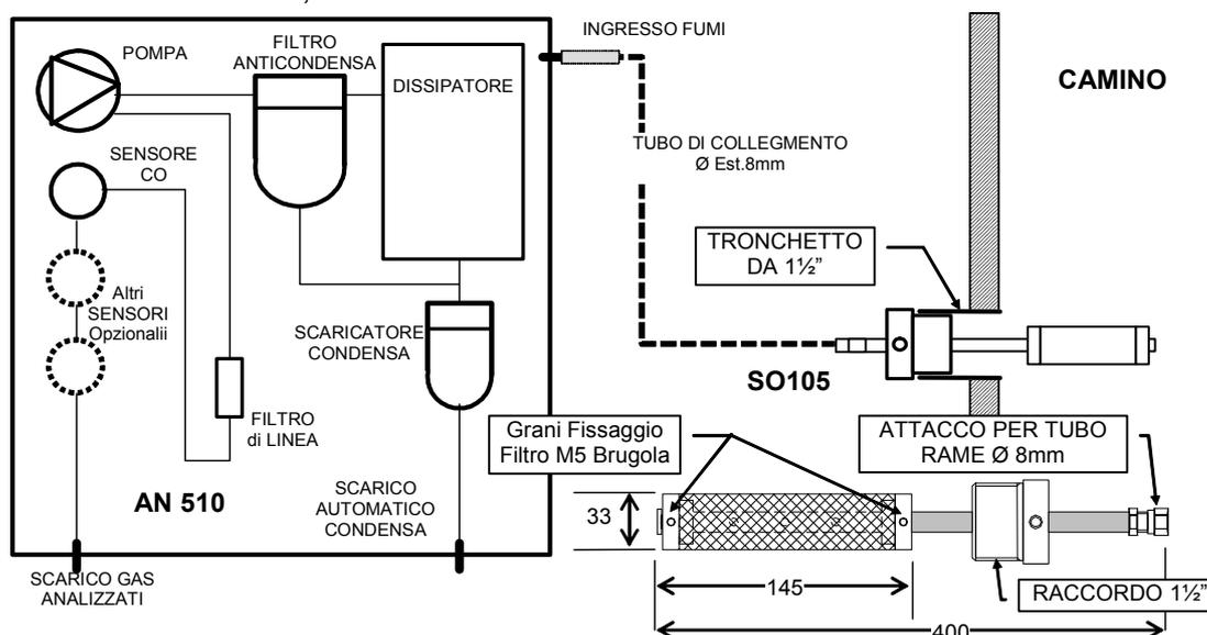
L'unità di analisi AN510 va installata in prossimità della caldaia da analizzare, tenendo conto delle caratteristiche ambientali d'esercizio, va installata in una zona che non superi i 45°C a prescindere dalla distanza tra il punto d'analisi e la posizione dell'installazione.
