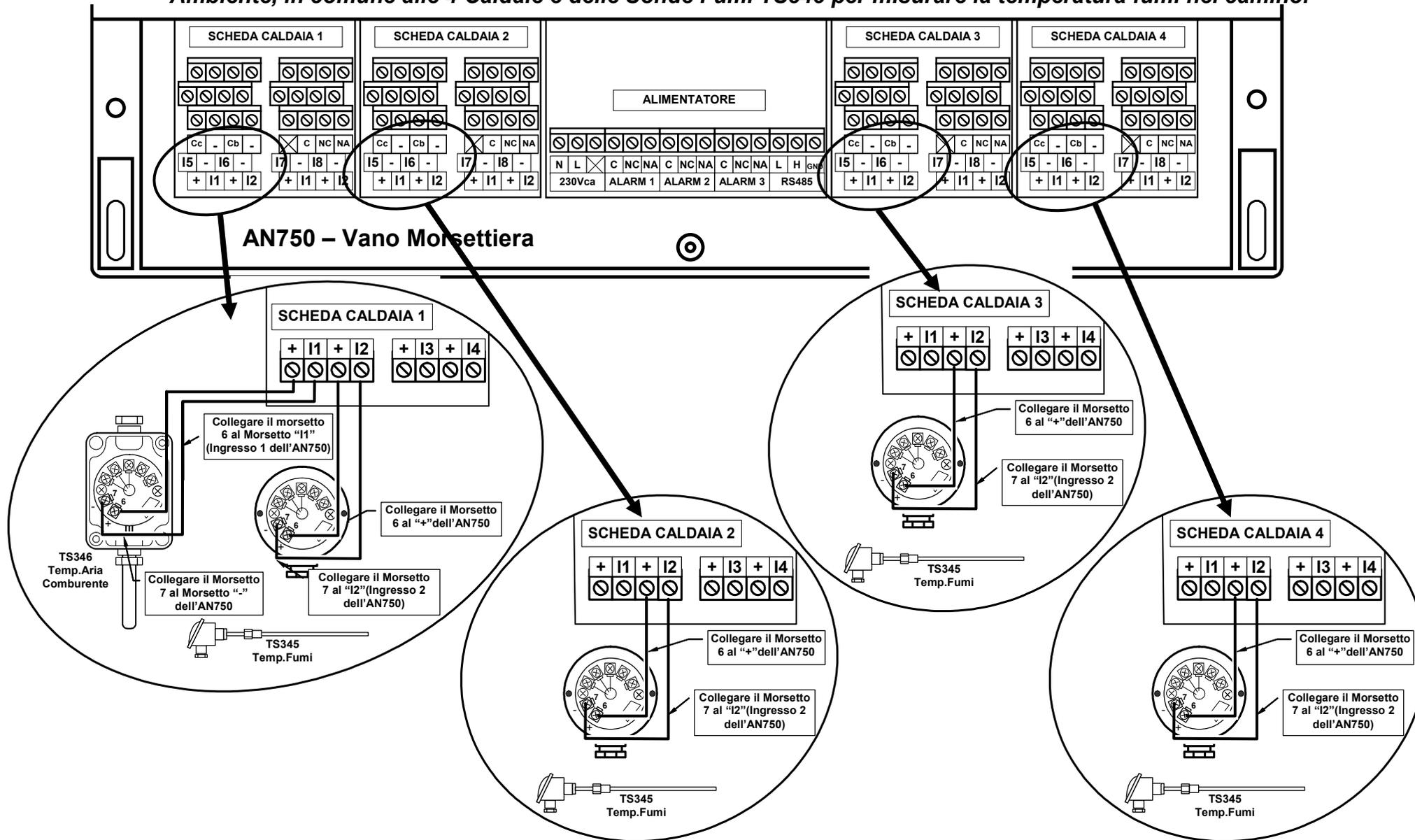
**SCHEMA 4** Sonde TS345 per Ta e Tf **Collegamento Sonde TS345 per misurare la temperatura Aria Comburente Preriscaldata al Bruciatore di ogni Caldaia e Sonde TS345 per misurare la temperatura dei fumi nei rispettivi raccordi camino.**
