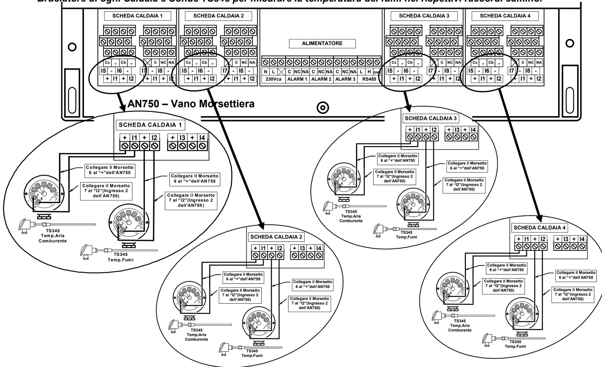
**SCHEMA 5 Consensi, Sonde TS236 e AN510 Collegamento Consensi, Sonda O<sub>2</sub> TS236 e Unità AN510 (/C, /CN,/CNS) alla scheda Caldaia e Relè di Guasto della scheda (Le altre schede caldaia si collegano nello stesso modo)**
