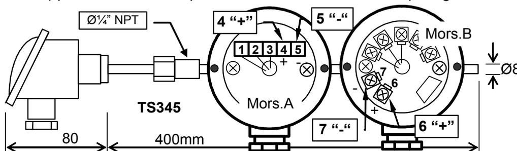
Per misurare la temperatura fumi (Tf) va installata sul raccordo camino tramite un tronchetto Femmina da  $1/4$  NPT. Il Raccordo in dotazione permette di regolare la posizione della sonda.
