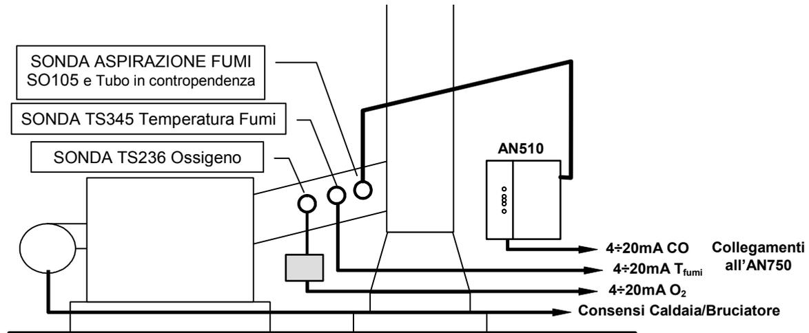
Se il raccordo camino è corto si possono installare le sonde sul camino ad una distanza pari a due diametri dello stesso a partire dall'innesto del raccordo camino.
