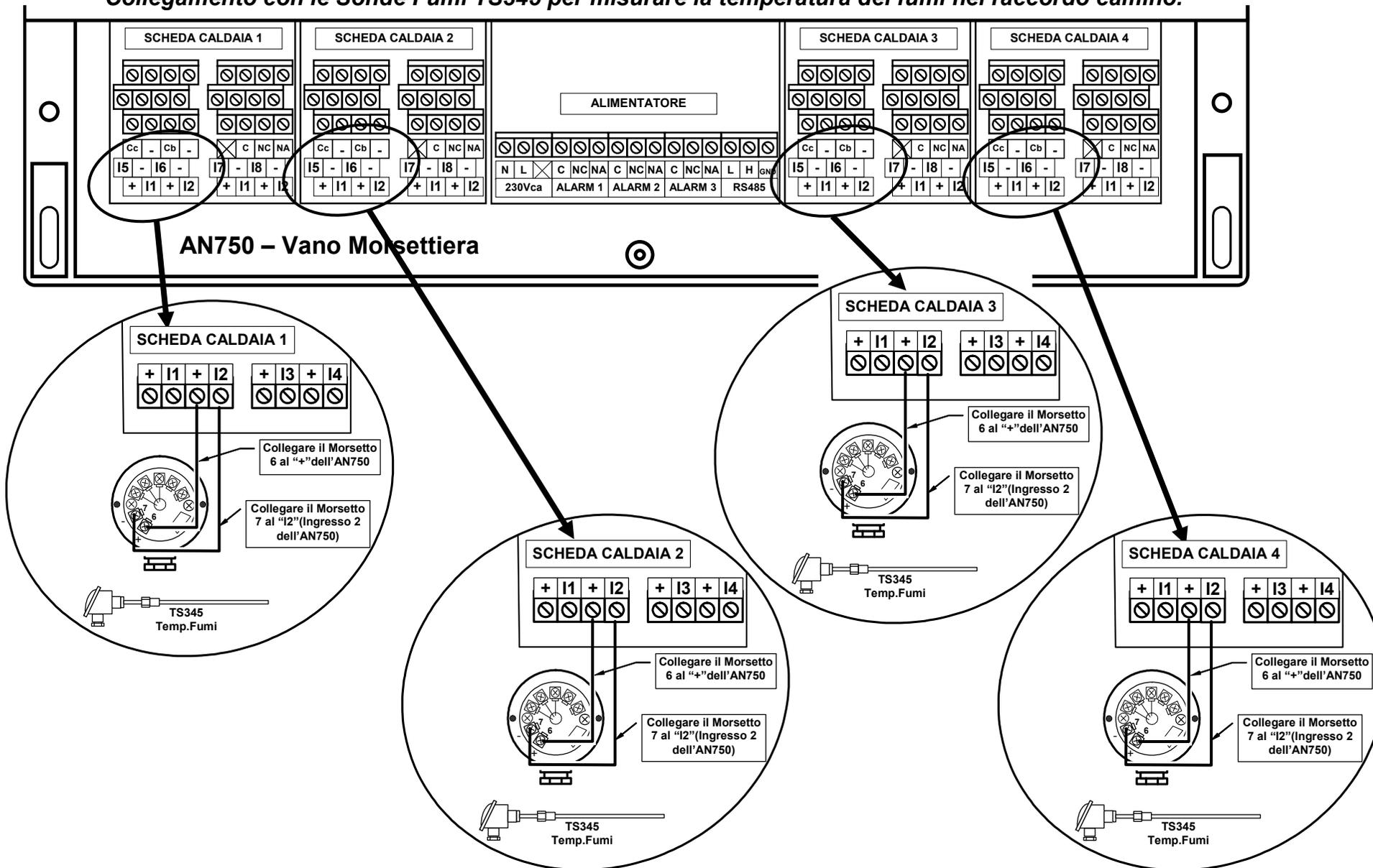
**SCHEMA 3** Sonde TS345 Tf e TS346 Ta in comune **Collegamento di una Sonda TS346 per misurare la temperatura Aria Ambiente, in comune alle 4 Caldaie e delle Sonde Fumi TS345 per misurare la temperatura fumi nel camino.**
