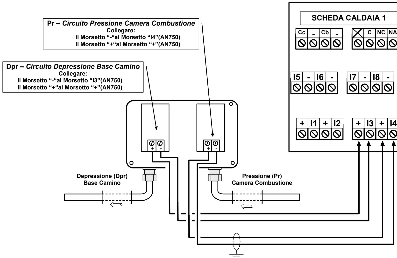
**SCHEMA 8** Unità AN400/I **Collegamento dell'Unità Analisi CH<sub>4</sub> in camera di combustione AN400/I alla scheda Caldaia (Le altre schede caldaia si collegano nello stesso modo). Per le altre informazioni tecniche fare riferimento alle specifiche istruzioni.**
