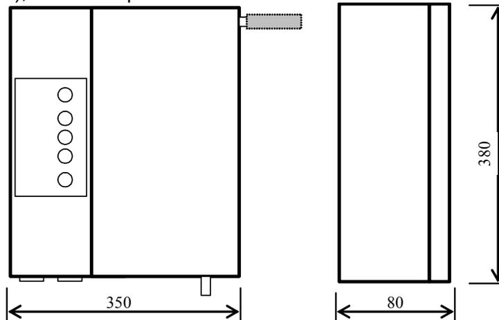
All'interno si trova il circuito d'alimentazione, i trasmettitori 4÷20 mA, il circuito d'aspirazione fumi per la misura della concentrazione di CO e la morsettiera di collegamento.
