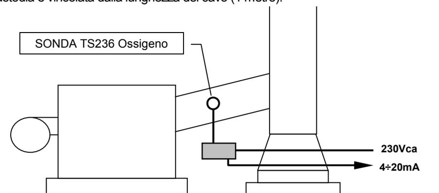
Se il raccordo camino fosse troppo corto si può installare la sonda sul camino ad una distanza pari a due diametri dello stesso dall'innesto del raccordo camino.
