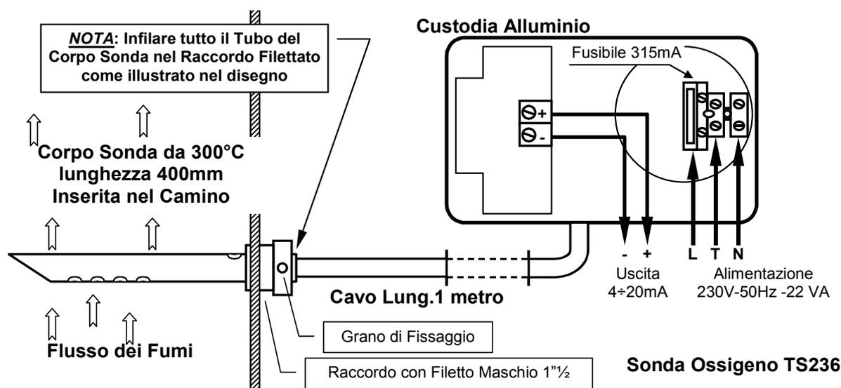
La sonda TS236 viene fornita con il Corpo Sonda standard adatto a temperature di fumi fino a 300°C. A richiesta è disponibile la TS237 per temperature fumi fino a 600°C (Disegno sotto)
